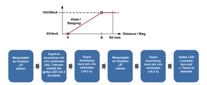
Achtung: die Programmierung für den max. Hub muss innerhalb einer Minute erfolgen. Andernfalls fällt der Sensor in den zuletzt programmierten Modus zurück.
